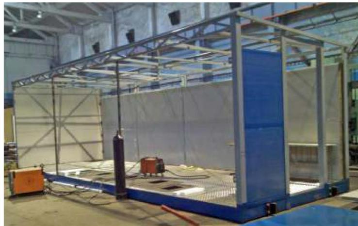
**Конструкция блок-контейнера, исключая образование «мостиков холода»**
