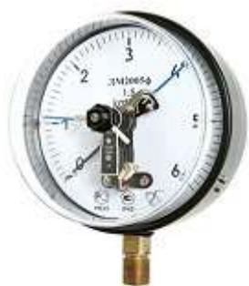
Мановакуумметры электроконтактные (сигнализирующие) ДА 2005 предназначены для измерения избыточного и вакуумметрического давления неагрессивных, некристаллизующихся жидкостей, пара, газа в том числе кислорода и управления внешними электрическими цепями путем включения и выключения контактов.
