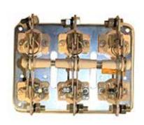
Рубильники серии Р открытого исполнения, трехполюсные, с ручными приводами зависимого действия, для переднего присоединения проводников с выводами в плоскости монтажа (для рубильников на 100А и 250А) и перпендикулярно плоскости монтажа (для рубильников на 400А и 630А), обладающие свойствами разъединителей (в дальнейшем аппараты), предназначены для нечастых (не более 6 в час) неавтоматических коммутаций электрических цепей переменного тока частотой 50Гц, напряжением 380В.
